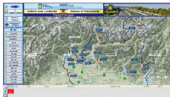
Fig.2 - Il sistema di supervisione e telecontrollo, progettato e realizzato da Gemmo S.p.A., è basato sullo Scada PcVue di ARC Informatique
